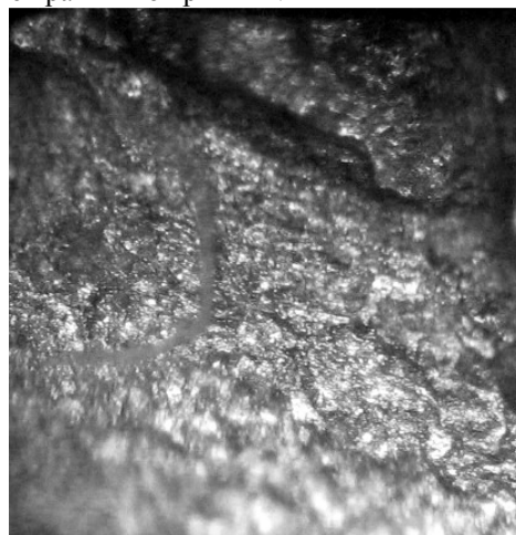
Рис. 5. Типова оптична фотографія зламу сплаву після циклічних випробувань на вигин. Збільшення \times 150
