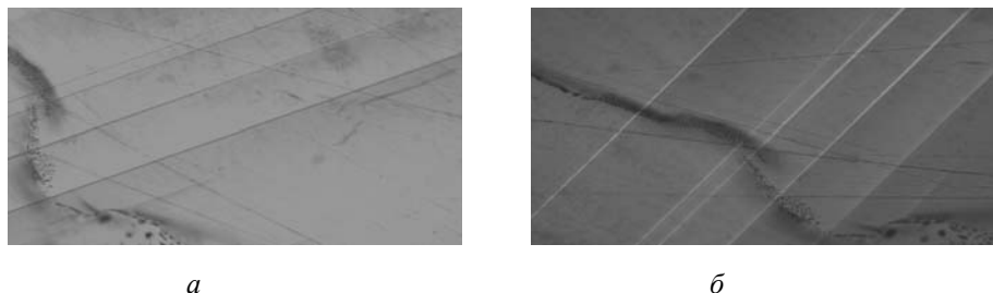
Рис. 4. Доменна структура кристала \text{TtMA-CuCl}_3 за кімнатної температури при різних положеннях столика мікроскопа, що відповідають затемненню двох груп доменів
