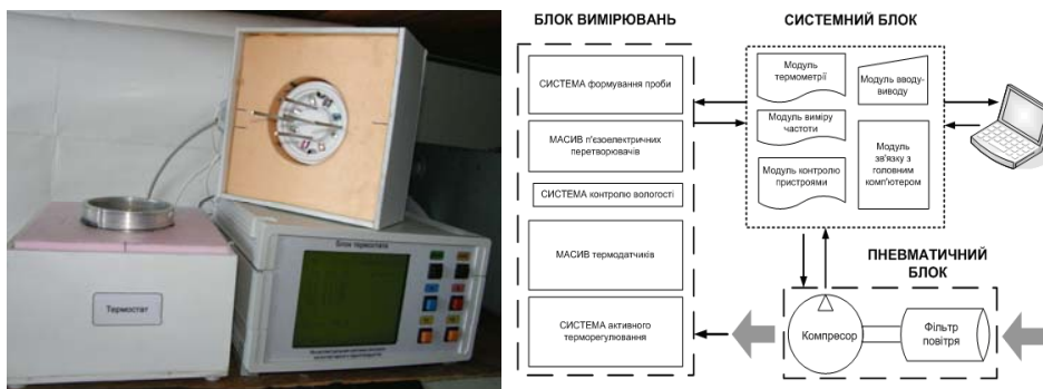
Рис. 1. Загальний вигляд приладу (а) та блок-схема системи "GRAINOSE" (б)
