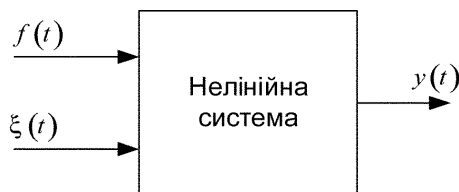
Рис. 1. Узагальнена схема для дослідження стохастичного резонансу.
