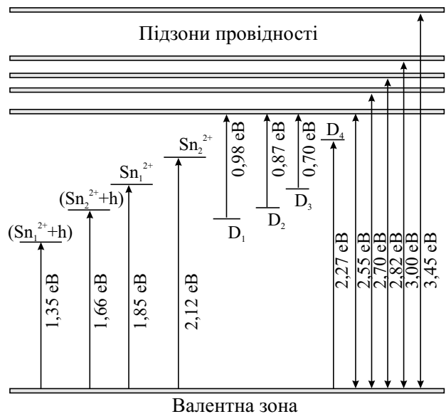
Рис. 6. Схема енергетичних рівнів дефектів й електронних фотопереходів у кристалі \text{Sn}_2\text{P}_2\text{S}_6 [17].
