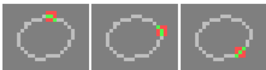
Рис. 4. Ділянка, до якої застосовано ядро SSC ( \bullet, \bullet, 3 ), зображена 3 \times 3 квадратом із червоними та зеленими пікселями. Активні елементи в ньому позначені зеленим кольором. Червоні ігноруються SSC, унаслідок чого крива зберігає свою структуру [9]
