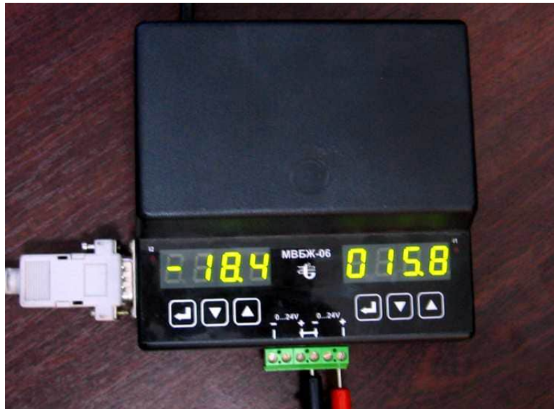
Рис. 1.3. Блок живлення з керуванням від мікроконтролера. Видно індикатори двох вихідних напруг та роз'єднання (ліворуч) для його з'єднання з ПК через порт RS232
