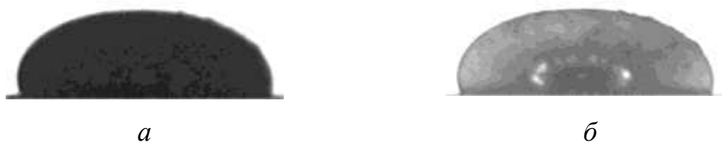
Рис. 4.4. Фотографія краплі розплаву за температур T = 300^{\circ}\text{C} ( a ) та T = 500^{\circ}\text{C} ( б )
