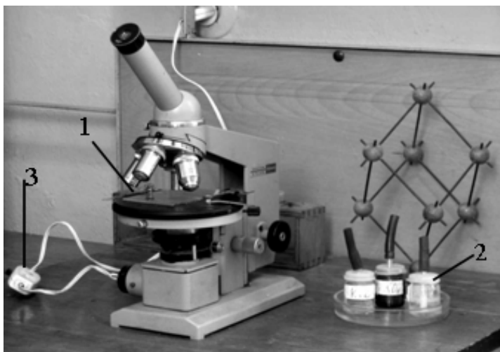
Рис. 20.1. Мікроскоп за допомогою якого спостерігають за кристалізацією з перенасиченого розчину.
