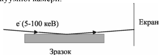
Рис. 8. Схематичне зображення експериментальної установки ДШЕВ.
