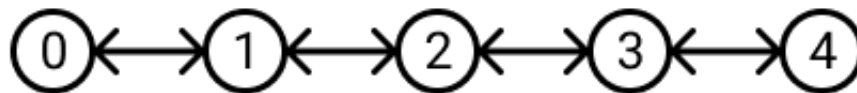
Рис. 2: Архітектура квантового комп'ютера ibmq_athens . Стрілками показано, між якими з кубітів можна прямо застосовувати оператор CNOT . Напрявленість стрілок в обидва боки означає, що кожен кубіт може виступати як керуючим, так і керованим.
