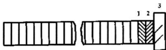
Рис. 4. Схема лазерного дзеркала: 1, 2 – почергові шари n_n і n_n , 3 – підкладка
