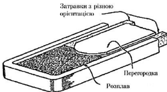
Рис. 7. Горизонтально-градієнтний спосіб вирощування кристалів (за Чалмерсом)
