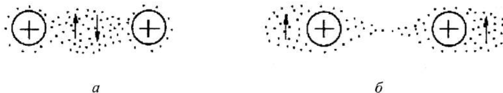
Мал. 3. Розподіл густин електричного заряду двох електронів у полі двох протонів для антипаралельної (а) та паралельної (б) орієнтацій спіну
