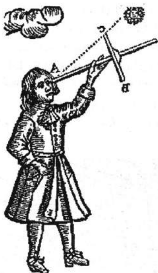
Посох Якова для визначення широти, на якій перебував корабель
